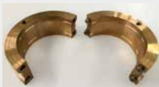
In radial geteiltem Design für leichtere Installation. Die 2 Hälften haben axiale Gewindebohrungen zum einfachen Entfernen der Bronzebuchse. Verschleiß Indikatoren sichern die Funktionstüchtigkeit.
