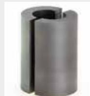
Die Kohlebuchse ist aus einem hochreinen Material mit > 99 % C-Gehalt und hoher Druckfestigkeit hergestellt. Präzise bearbeitete Toleranzen reduzieren den Spalt am Ende der Stopfbuchspackung auf ein Minimum und bieten eine Auflagefläche für dünnere und horizontal ausgerichtete Ventilspindeln. Die Länge der Buchse kann ohne weiteres auf die Tiefe
