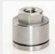
Das PROLOAD LiveLoading System passt auf die vorhandenen Stopfbuchschrauben und muss bei der Montage lediglich festgezogen werden, bis der sichtbare Montagespalt schließt.
