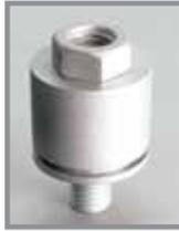
Das PROLOAD-STAT LiveLoading System wird einfach auf den vorhandenen Bolzen geschraubt. Die tassenähnliche Form beherbergt den unkomprimierten Federstapel und schafft in seiner Konstruktion die erforderliche Extralänge. Das System hält die gleiche Vorspannung bei Wärmeausdehnung der Ventile oder Flanschbauteile aufrecht. Der Federstapel kann nicht überpresst werden, weil die PROLOAD-STAT Gehäuseabmessung die optimale Vorspannung vorgibt.
