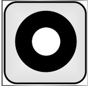
Der umflochtene Elastomer Schlauchkern gibt der Dichtung höchste Flexibilität und Rückstellvermögen in dynamischen und statischen Anwendungen.
