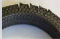
Entfernen Sie alle alten Packungsringe aus der Stopfbuchse. Markieren Sie die Ringe sofort und einzeln, wenn Sie diese herausziehen: Beispiel mit einem kleinen Markierungsschnitt oder Kerbe für den ersten Ring, zwei Schnitten für den zweiten Ring usw.
