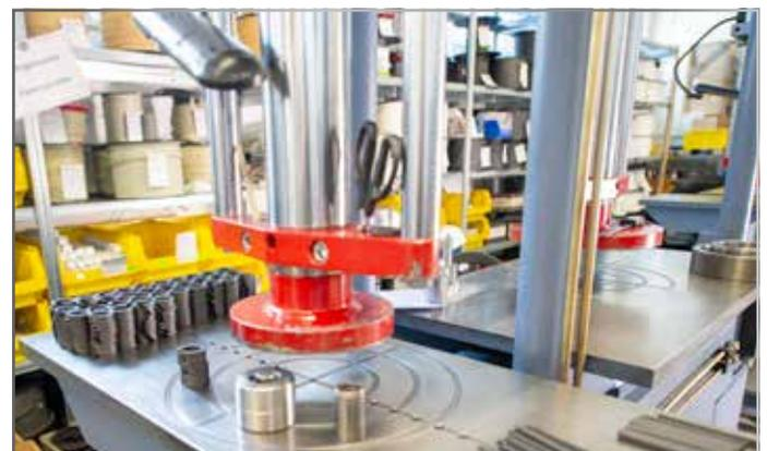
Spezielle, langsam laufende hydraulische Pressen
