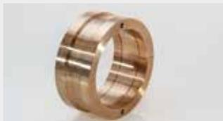
Für optimale Standzeiten wird der Einsatz dieser Bronzebuchse im Stopfbuchsraum empfohlen, damit die Rußbläserlanze auf die Packung keine einseitige, radiale Belastung ausübt.
