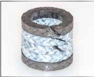
**Schritt 3 - Einbau von Anti-Extrusionsringen zur Verringerung des Spalts zwischen Stopfbuchse und Ventilspindel**
