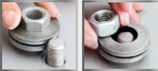
Der Stapel von Tellerfedern ist zu lang für die verfügbare Bolzenlänge. Neue Bolzen zu beschaffen ist zeit- und kostenaufwändig.
