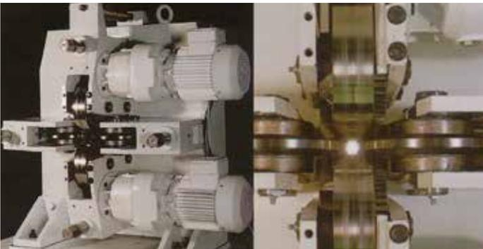
Die weitere Präzisions-Nachbearbeitung verwendet einen modernen Kalandrierer mit vier individuell einstellbaren Rollen. Dies erlaubt, die Abmessung in der Höhe und Breite der Packung exakt zu kontrollieren, zusätzlich den Oberflächenkontakt der Packung zu erhöhen und ihr Setzverhalten zu reduzieren.
