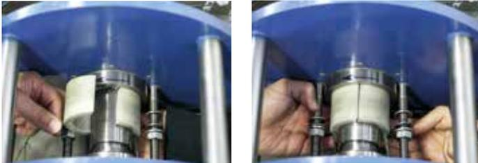
Versuchen Sie nicht alle Ringe gleichzeitig mit der Brille zu verdichten. Durch die Reibung an der Stopfbuchsbohrung, an der Welle und innerhalb der Packung werden die unteren Ringe ungenügend und die brillenseitigen Ringe zu stark verpresst.
