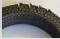
Entfernen Sie alle alten Packungsringe aus der Stopfbuchse. Markieren Sie die Ringe sofort und einzeln, wenn Sie diese herausziehen: Beispiel mit einem kleinen Markierungsschnitt oder Kerbe für den ersten Ring, zwei Schnitten für den zweiten Ring usw.
