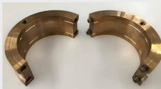
In radial geteiltem Design für leichtere Installation. Die 2 Hälften haben axiale Gewindebohrungen zum einfachen Entfernen der Bronzelagerbuchse. Verschleiß Indikatoren sichern die Funktionstüchtigkeit.
