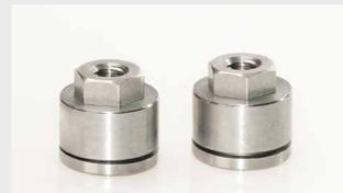
Die beste Funktion mit unserem Rußbläser Packungssatz erreicht man in Verbindung mit Proload LiveLoading in einer speziellen Ausführung mit weicher Federkraft und langem Federweg L10RB, L12RB oder L3/8RB, L1/2RB. Das LiveLoading System stellt die Verpressung des Packungssatzes auch bei Lastwechsel, bei Temperaturschwankung oder bei Verschleiß und Nachsetzen der Packung sicher.
