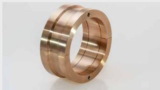
Für optimale Standzeiten wird der Einsatz dieser Bronzelagerbuchse im Stopfbuchsraum empfohlen, damit die Rußbläserlanze auf die Packung keine einseitige, radiale Belastung ausübt.
